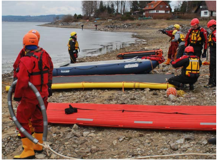
Tratwa pneumatyczna według autorów najlepsze rozwiązanie jeśli chodzi o ratownictwo na kruchym lodzie z widzianym z lewej ciekawym zakończeniem pętli na linie ratowniczej
